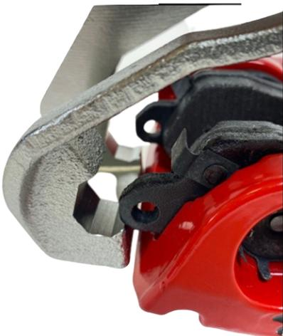
**HOOK THE CURVED INSIDE NOTCH ON THE ANCHOR AROUND THE PADS AS SHOWN.**
